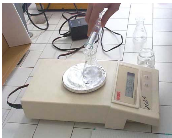
Aggiunta dell'acido cloridrico al marmo in polvere
