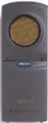
Il funzionamento dei rivelatori sonici di movimento si basa sulla misura dell'intervallo di tempo che intercorre tra la trasmissione di un impulso di ultrasuoni, emesso dal rivelatore stesso, ed il primo eco di ritorno dovuto al rimbalzo dell'impulso sull'oggetto più vicino.
