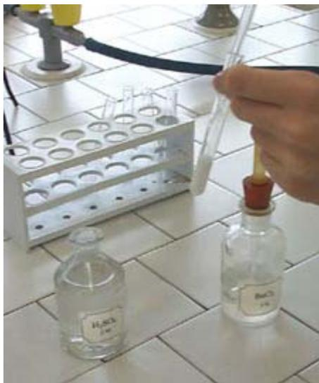
Abbiamo fatto reagire il cloruro di bario con l'acido solforico formando solfato di bario insolubile e acido cloridrico; il solfato per la sua insolubilità ha reso la soluzione bianca opaca.
