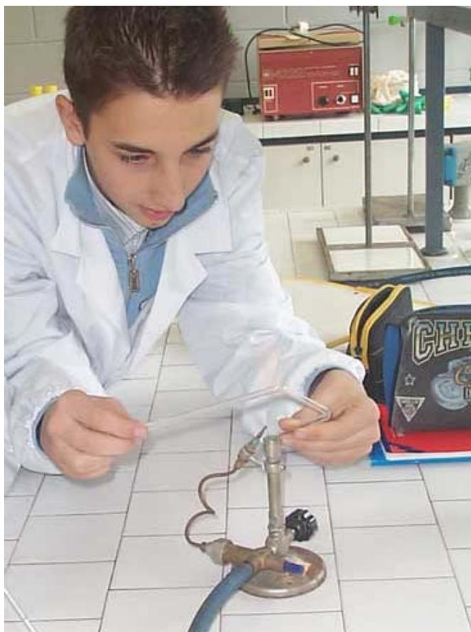
*Nella foto si può vedere il tubo piegato due volte: quando si piega il tubo, è meglio tenerlo sul bunsen per evitare che si raffreddi e che si rompa.*
