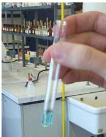
Abbiamo fatto reagire nella prima provetta il rame metallico, ottenuto tagliando a pezzetti l'anima di un cavetto per impianti elettrici, con l'acido nitrico formando nitrato rameico in soluzione e ossido d'azoto che, essendo un gas, gorgogliava nella soluzione di color azzurro. E' bene non annusare la soluzione perché è tossica.
