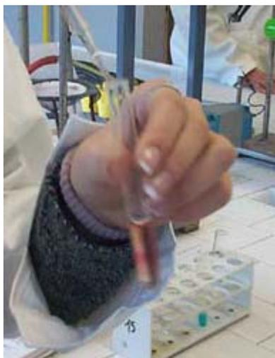
Abbiamo fatto reagire nella seconda provetta il permanganato di potassio che ha un bel colore viola con il solfato ferroso già precedentemente mischiato con l'acido solforico. Man mano che si aggiungevano questi composti la soluzione decolorava per la formazione di solfato di potassio, solfato di manganese, solfato ferrico e acqua. Alla fine la soluzione è diventata completamente trasparente.
