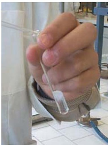
Abbiamo fatto reagire nella terza provetta il solfato di alluminio con due gocce di idrossido di sodio formando idrossido di alluminio e solfato di sodio: nella provetta si sono formati degli anelli gelatinosi semi-trasparenti dovuti alla presenza dell'idrossido di alluminio.
