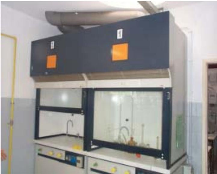
La **cappa** è una grande apparecchiatura con un'apertura nella parte bassa e un aspiratore nella parte alta. La cappa permette l'esecuzione in modo sicuro di reazioni che comportano lo sviluppo di gas tossici.
