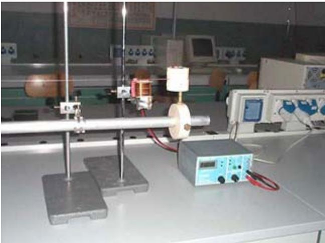
Poiché l'ampiezza di oscillazione della lamina è molto piccola, l'estremità della corda a essa attaccata si può considerare con buona approssimazione fissa. Pertanto, variando la frequenza  $f$  di oscillazione della corda si ottiene la formazione di onde stazionarie di lunghezza d'onda:
